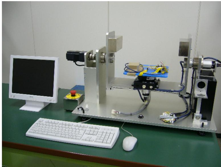
ワコーが提供する6軸運動センサ自動測定装置は、加速度及び角速度を測定する装置です。また、回転振動を与えて、角速度の周波数特性を簡便に測定することもできます。測定はコンピュータ(PC)によって制御され自動で行われます。測定結果は、画面上のグラフで確認することができ、データはCSV形式でファイルに保存されるためデータの解析が容易となります。本装置を使用することで、加速度センサ及び角速度センサの特性試験に要する時間が大幅に短縮され、幅広く利用できます。
